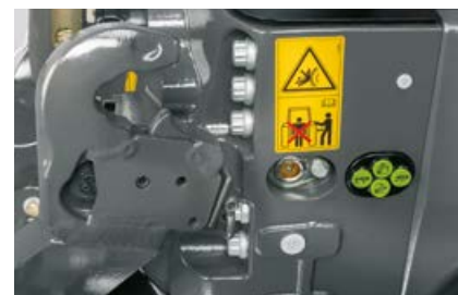
Commande extérieure du relevage avant et d'un distributeur.
