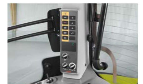
Présélection des régimes de prise de force et relevage arrière électronique installés sur le montant arrière droit de la cabine.
