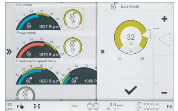
Réglage de la chute de régime moteur autorisée pour les modes « Eco » et « Power » ainsi que pour la mémoire de régime moteur.
