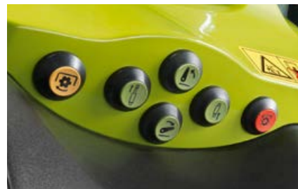
Commandes extérieures pour le relevage arrière, la prise de force et un distributeur au choix.
