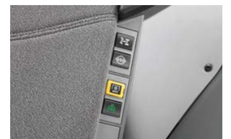
Activation de la suspension du pont avant.
