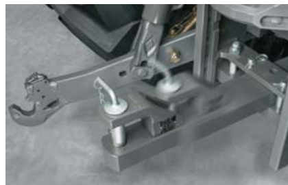
Les modèles de barre oscillante proposent plusieurs positions. La position déployée permet une maniabilité supérieure.
