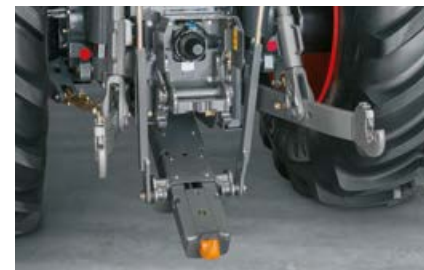
Un attelage par crochet ramasseur peut remplacer l'échelle à glissière conforme à la norme ISO 500.
