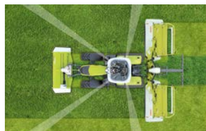
Grâce à la disposition particulière des montants arrière de cabine et à la vitre arrière galbée, le conducteur bénéficie d'une vue dégagée sur l'outil et la zone d'attelage.
